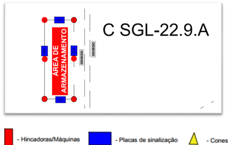
Figura 29 - Armazenamento de materiais.
